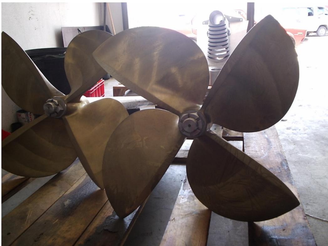
Рис.2. Внешний вид гребного винта Арнесона
