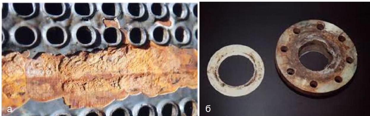
Рисунок 8: а - гальваническая коррозия на поверхности меди в контакте со стальными трубами и б - щелевая коррозия
