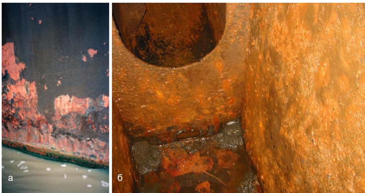
Рисунок 5: а - коррозия в районе пояса переменных ватерлиний и б - в балластном танке
