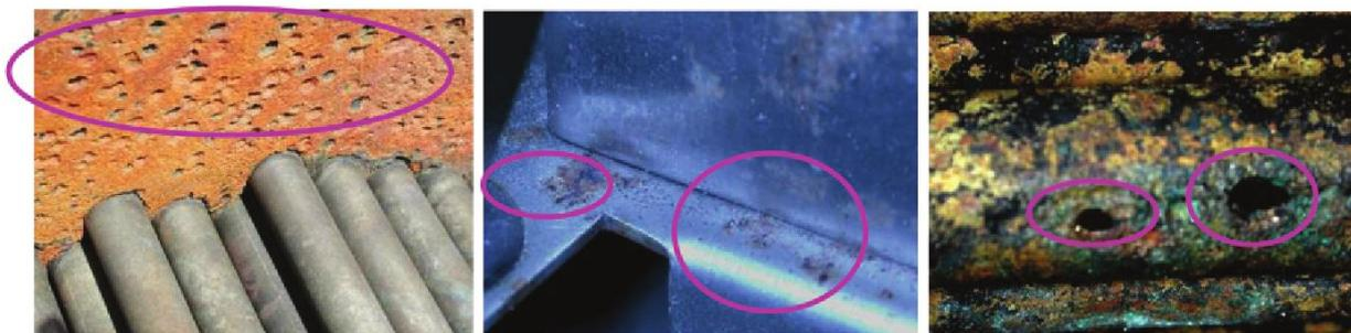
Рисунок 9 - Точечная коррозия
