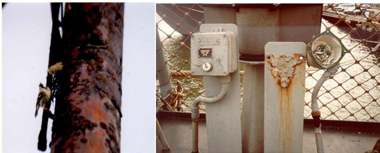
Рисунок 2 - Примеры атмосферной коррозии на надводных участках морского судна
